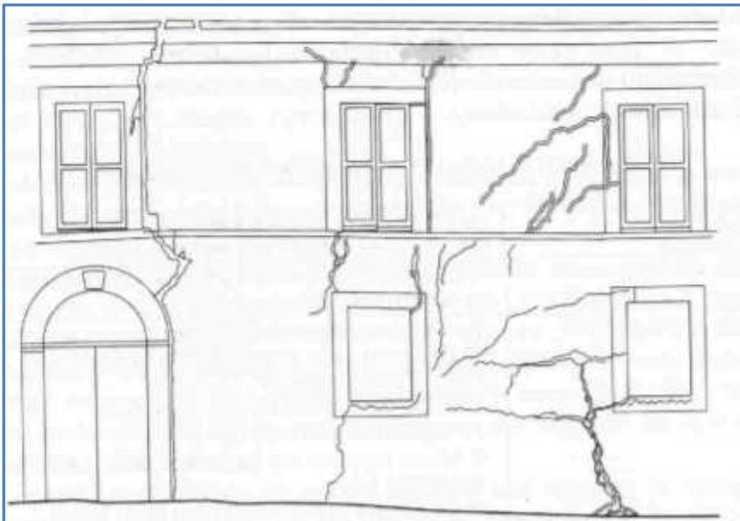
Fig.2 : Quadro fessurativo da fotogrammetria architettonica
