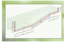
>> LA SEZIONE LONGITUDINALE DI UNA PISCINA CONSENTE UNA CHIARA VISUALIZZAZIONE DELLE ARMATURE.
