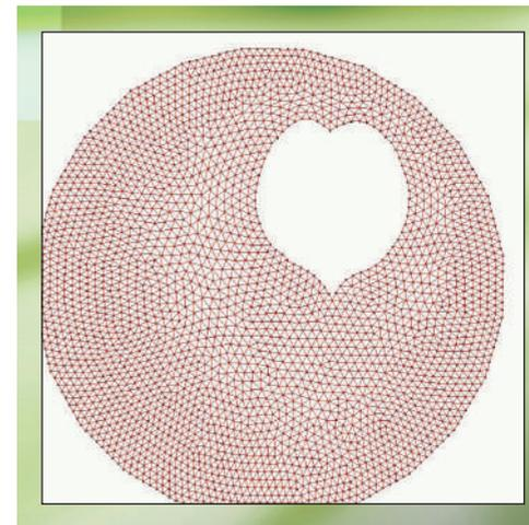
>> **NÒLIAN** CONSENTE LA GENERAZIONE AUTOMATICA DI MESH. QUI LA GENERAZIONE FRONTALE NEL CONTORNO DI UNA SUPERFICIE A CONTORNI CURVI CON APERTURE. SI PUÒ NOTARE CHE I CONTORNI CURVILINEI POSSONO ANCHE ESSERE GESTITI TRAMITE SPLINE.
