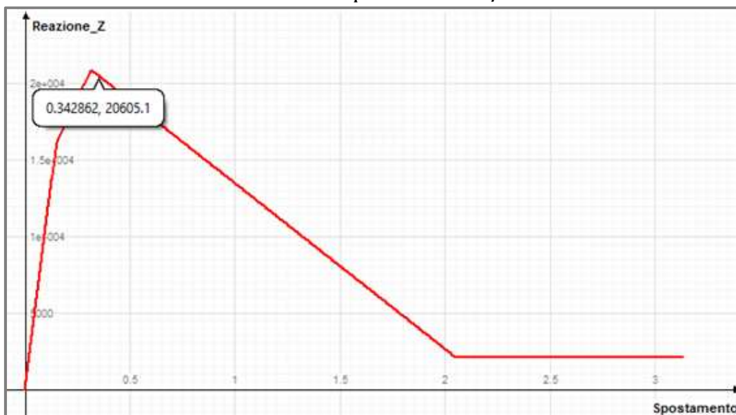
Figura 54: Definizione dei puntoni equivalenti con assegnazioni ad elementi boundary (NLINK)
