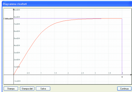
Trave a fibre con il solo contributo dell'acciaio. Diagramma forza assiale spostamenti all'aumentare del carico.
