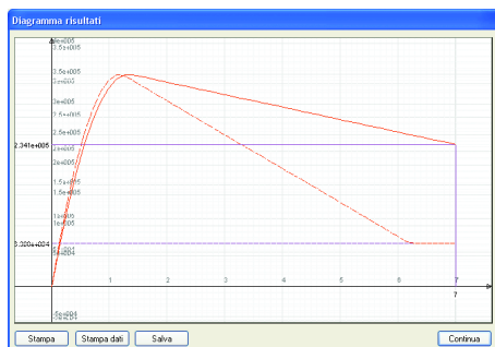
Il diagramma forza-assestamento del pilastro in Nölian con diversi gradi di confinamento.
