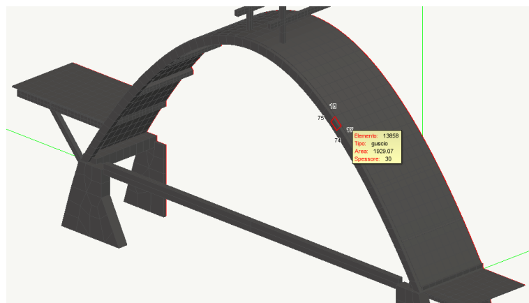
Figura 5.58 - Sezione del modello solido della struttura in cui si può notare la mesh di una costola.
