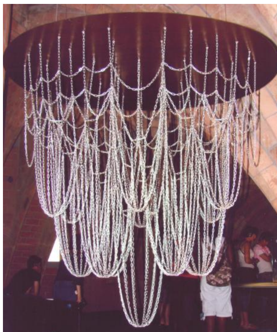
Figura 1.5 - Studio sull'arco catenario da parte di Antoni Gaudì a Barcellona. 1
