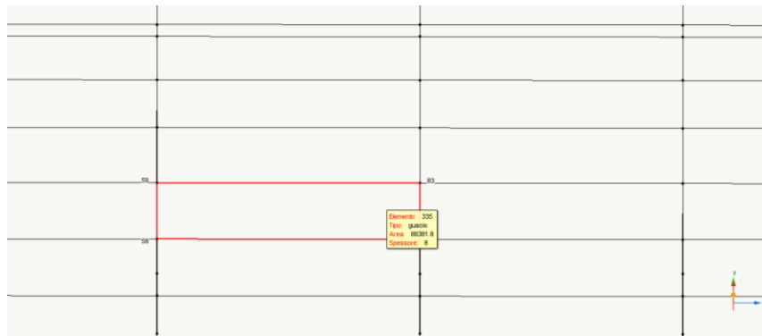
Figura 5.10 - Mesh del guscio del Modello 1. Essa risulta costruita erroneamente in quanto gli elementi sono troppo allungati.
