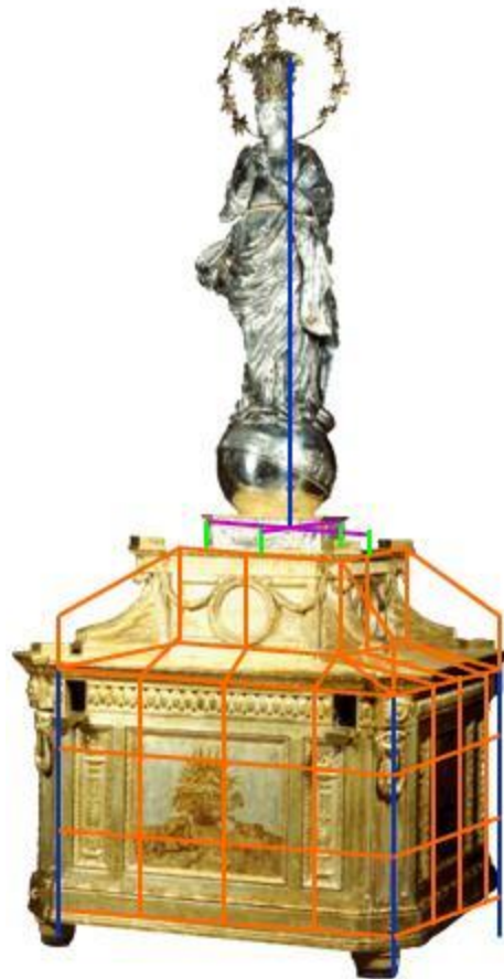
Figura 4.4. Sovrapposizione immagine reale del simulacro e modello di calcolo.
