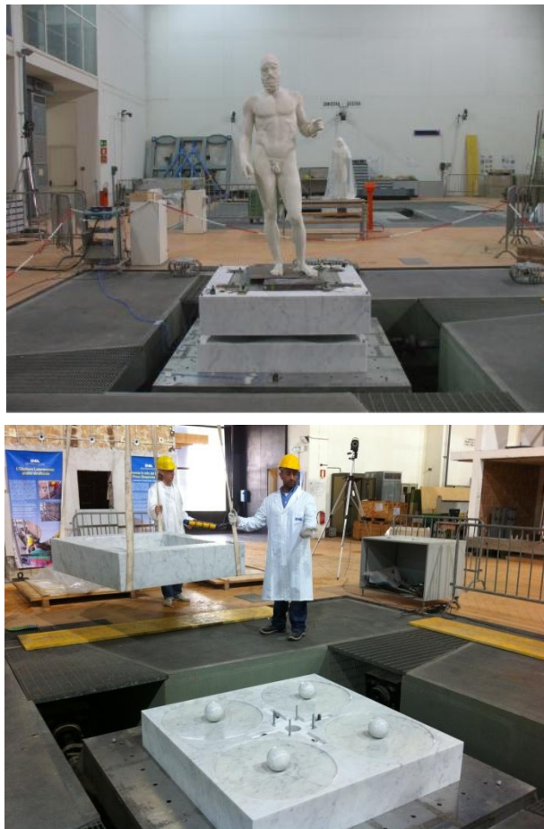
Figura 1.16. Verifiche sperimentali delle nuove basi antisismiche, sulle “tavole vibranti” presso i laboratori di “Qualificazione di Materiali e Componenti” del Centro Ricerche ENEA della Casaccia (vicino Roma).
