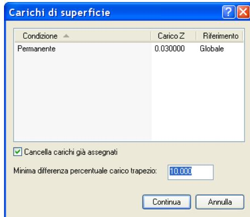
Qui immaginiamo un carico di 300 kg/mq e poiché le unità di misura che stiamo usando sono invece kg e cm, si ha un carico unitario di 0.03 kg/cmq.
